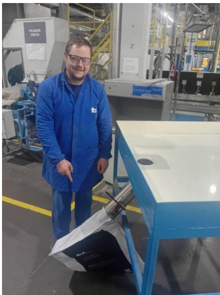
Figuras 4 e 5 - Djonata Gabriel de Souza, Operador I, do departamento TPE, demonstrando a ideia do funil feito na mesa de PPM para evitar o desperdício do material
