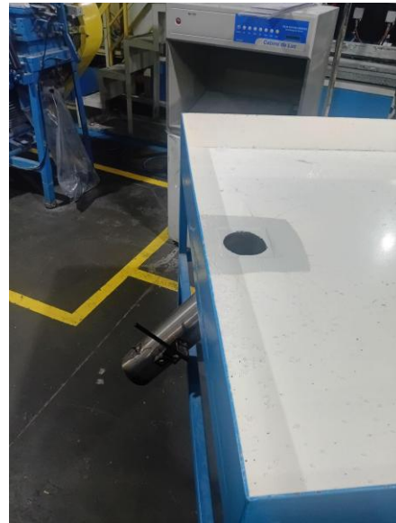
Figuras 4 e 5 - Djonata Gabriel de Souza, Operador I, do departamento TPE, demonstrando a ideia do funil feito na mesa de PPM para evitar o desperdício do material
